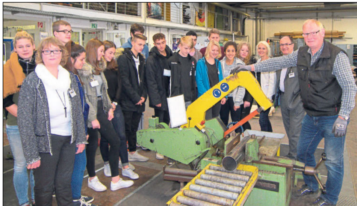
Anschauungsunterricht: Gerd Aschoff, Leiter der mechanischen Werkstatt (rechts), zeigt den Jugendlichen die Funktion einer Bügelsäge, mit der Rohre zersägt werden. Foto: Ibeler
